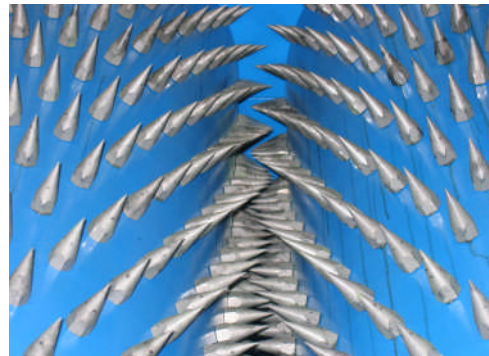
Blick auf den Rotor eines PET-Perforators
