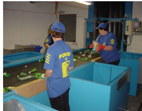
Handsartierung nach einer elektronischen Sortierung als Inspektorlösung
